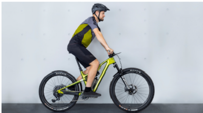
Obr. 11: Nastavenie tlmičov pomocou vodiča
